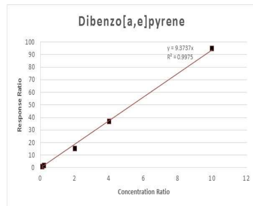
图五十三 Dibenzo[a,e]pyrene 标准溶液工作曲线
